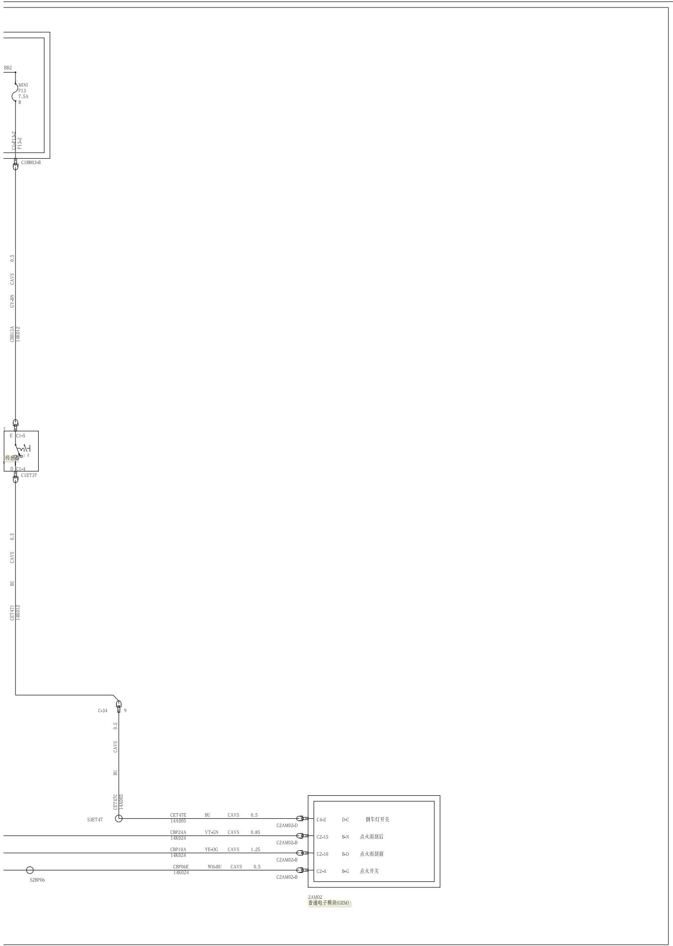
501-16-10 刮水器和洗涤器—5门, 车辆配备: 5—速手动变速器 (B5A)
